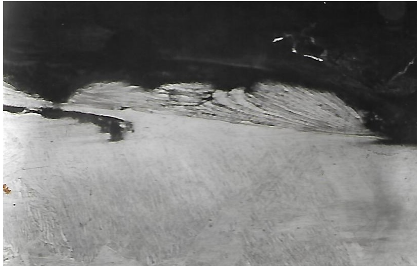
Obr. 1.32 Vznik triesky pred brúsnym zrnom pri brúsení titánovej zliatiny VT-6
