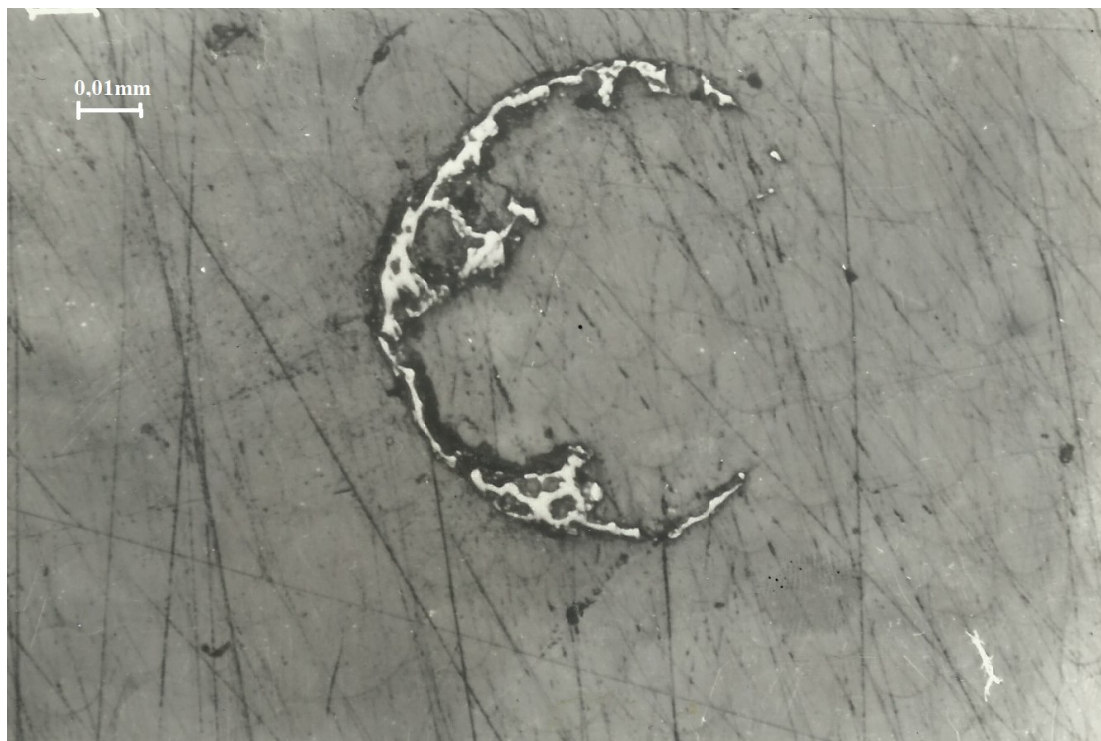
Obr. 2.6 Metalografický výbrus v reze guľovej triesky z brúsenia ocele C45
