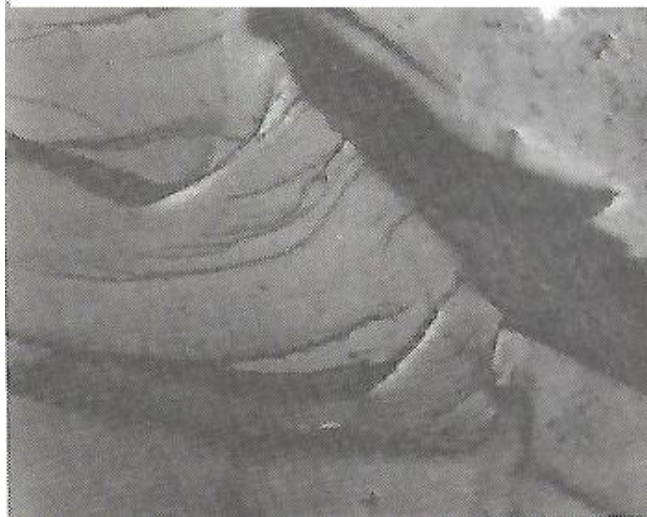
Obr. 3.9 Elektrónová mikrofotografia povrchov zrna zo syntetického diamantu po krehkom porušení pri brúsení bezvolframového spekaného karbidu
