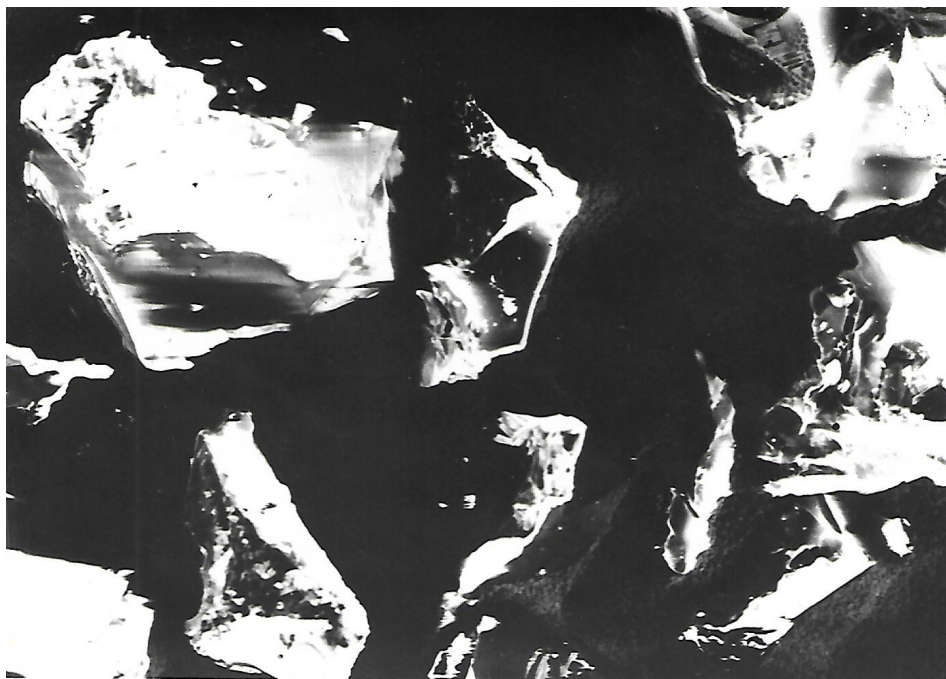
Obr. 3.3 Pohľad na fragmenty zrn po brúsení, pri rovnakom zväčšení
