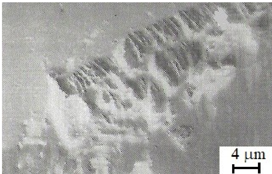
Obr. 3.26 Pohľad na reznu hranu diamantového zrna pri brúsení titánu VT 1-1
