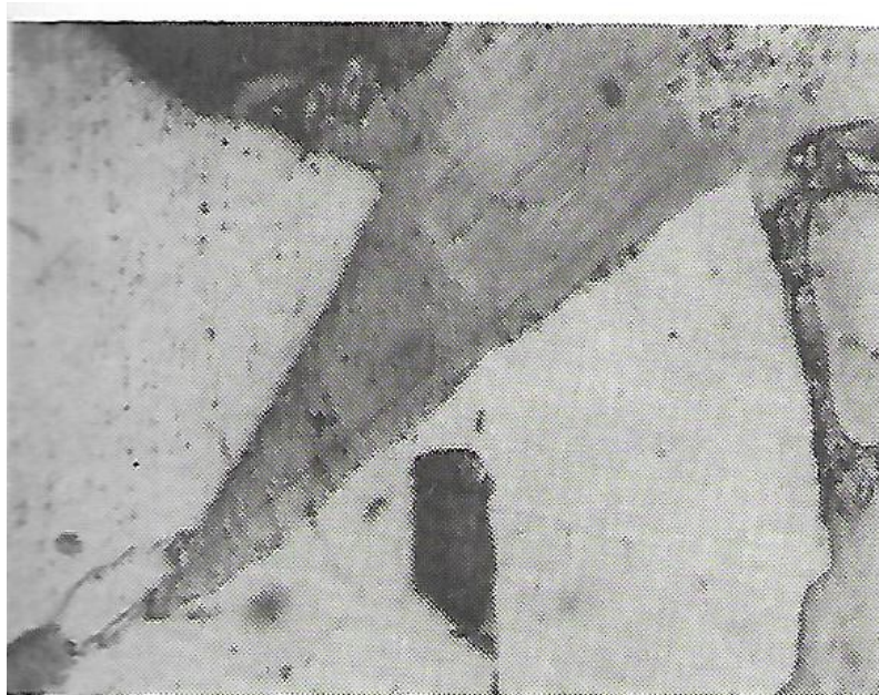
Obr. 4.1 Mikrofotografia zóny kontaktu keramického spojiva a elektrokoruddového zrna
