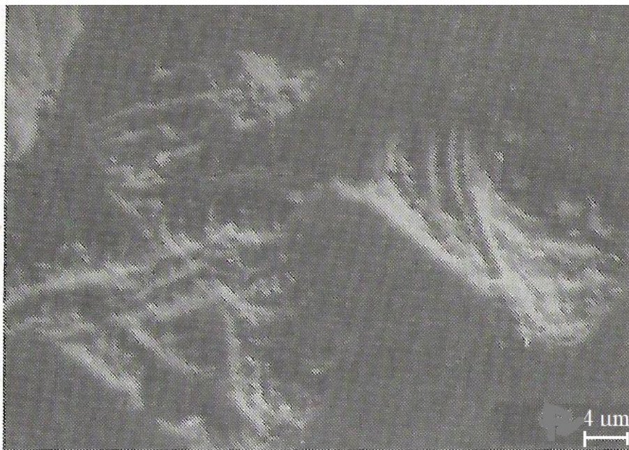
Obr. 3.27 Chrbtová plocha diamantového zrna po krátkom brúsení spekaného karbidu P20
