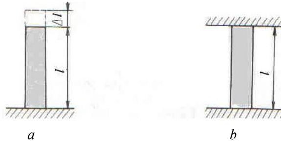
Obr. 2.24 Predĺženie voľného prúta (a) a vznik napätia vo votknutom prúte (b) vplyvom ohrevu na rovnakú teplotu
