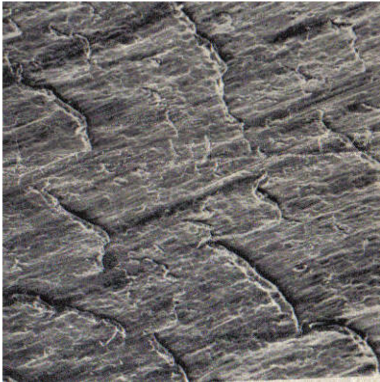
Obr. 7.23 Pohľad na obrobený povrch s pozdĺžnou mikronerovnosťou.
