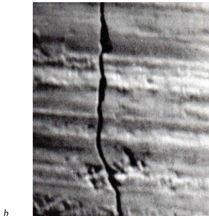
Obr. 5.28 Trhliny na brúsenom povrchu nástroja zo spekaného karbidu(a) a zväčšená trhlina (b)
