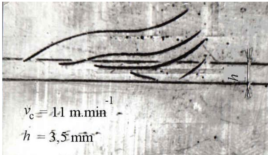
Obr. 1.36 Fotografia zápisu dráhy elementov materiálu pri prechode do triesky
