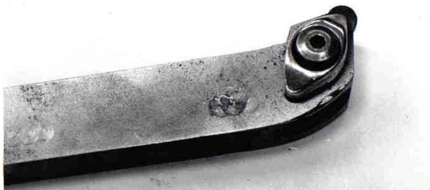
Obr. 7.70 Nástroj s kruhovou reznou platničkou s r_e = 5 \text{ mm}
