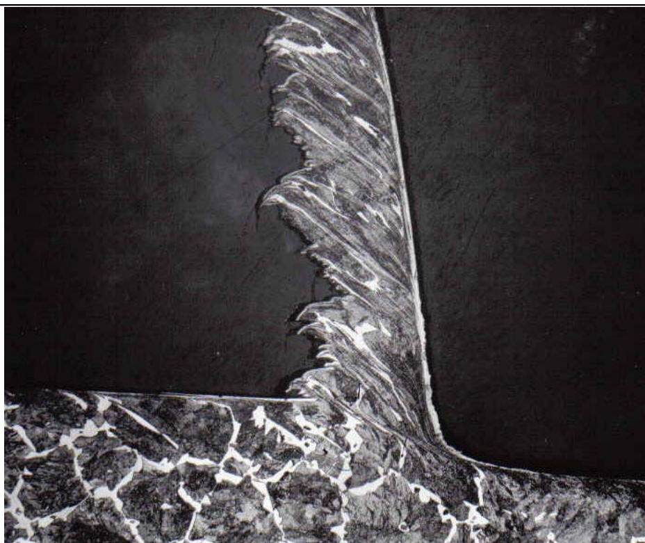
Obr. 1.50 Prejav plastickej deformácie pred rezným klinom pri obrábaní nástrojom so záporným uhlom čela. obrobok: C45, nástroj P20, v_c = 100 \text{ m.min}^{-1}
