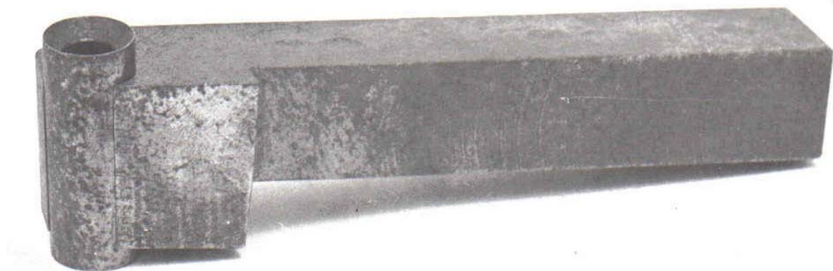
Obr. 6.58 Rúrkový sústružnícky nástroj
