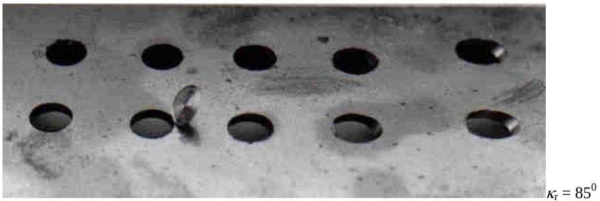
Obr. 3.19 Vplyv uhla nastavenia hlavnej reznej hrany skrutkovitého vrtáka na kvalitu vrtaných otvorov
