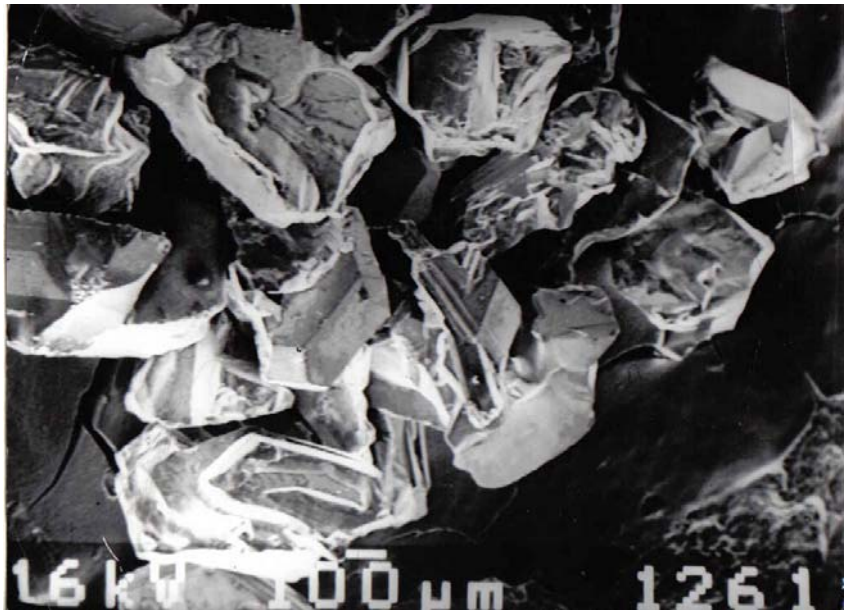
Obr. 7.37 Triedené voľné zrná z \text{Al}_2\text{O}_3
