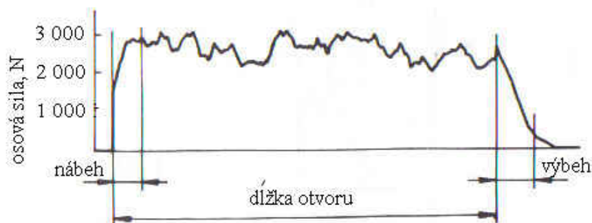
Obr. 9.132 Zmena osovej sily pri vŕtaní otvorov v sivej liatine vrtákmi z rýchloreznej ocele (19802 (HS12-1-2). Priemer vrtáka 12 mm, dĺžka otvoru 40 mm
