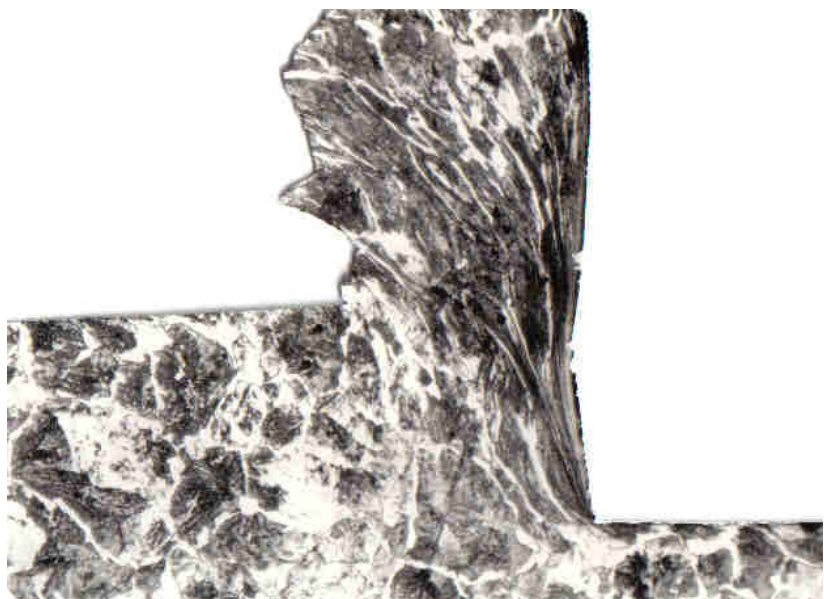
Obr. 3.12 Fotografia zóny tvorenia triesky, vzniknutej pri sústružení nástrojom s fázkou
