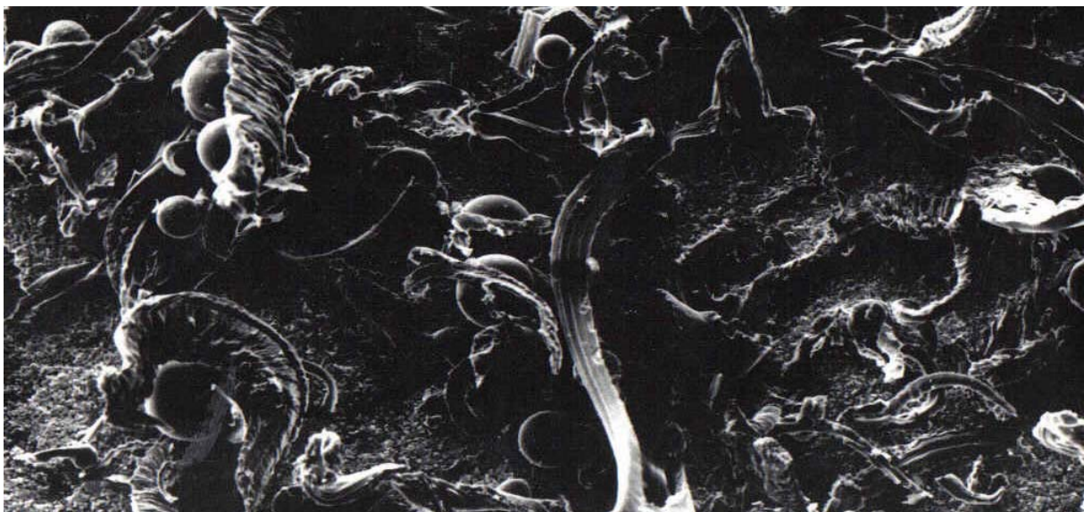
Obr. 7.38 Triesky, zachytené pri brúsení
