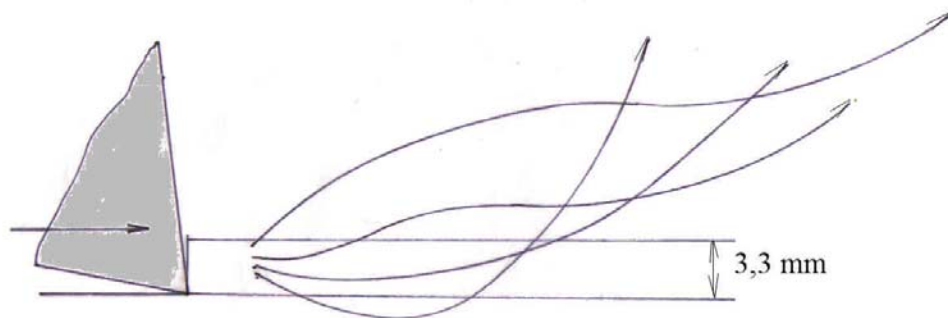
Obr. 1.37 Pohľad na krivky, nakreslené ihlami, odpovedajúcimi polohe elementov triesky
